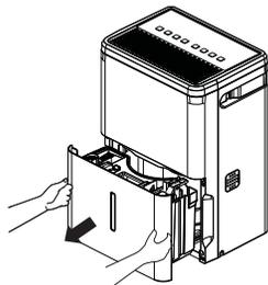
**IMPORTANTE:** No use la manguera si usa el tanque para recoger agua. Si la manguera está conectada, el agua caerá al piso en lugar de caer dentro del tanque.
